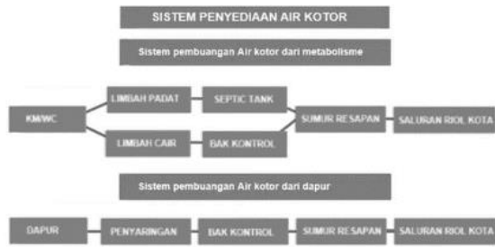
Gambar 14. Sistem Penyediaan Air Kotor (Sumber: Dokumen Pribadi, 2024 )
