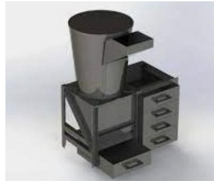
Gambar 1. Desain perancangan mesin pencacah sampah
